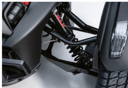
**VOLL EINSTELLBARE KYB<sup>®</sup> GASDRUCKSTOßDÄMPFER**
